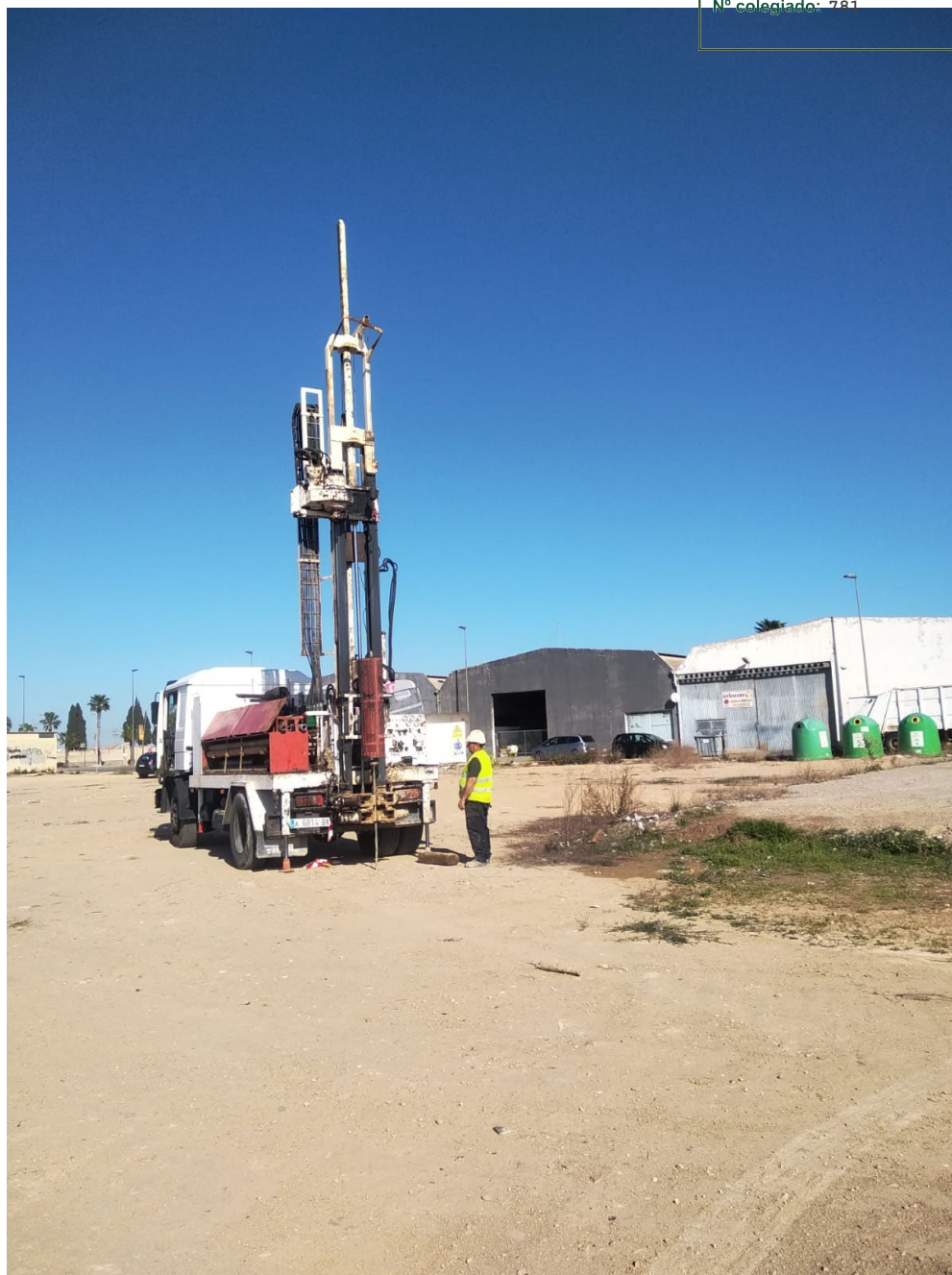
Ejecución del ensayo de penetración P-1.
